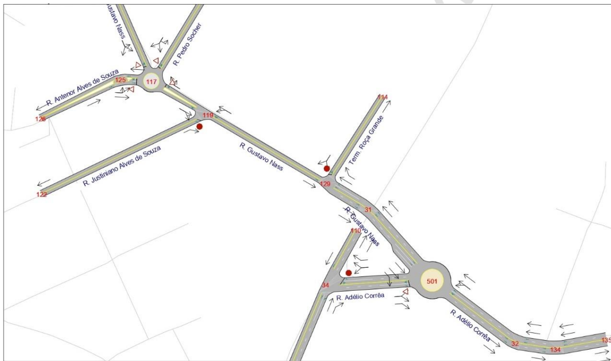
Figura 55 – Croqui esquemático rotatória na interseção Rua Gustavo Nass x Rua Pedro Socher e Rua Adélio Corrêa x Rua Gustavo Nass
