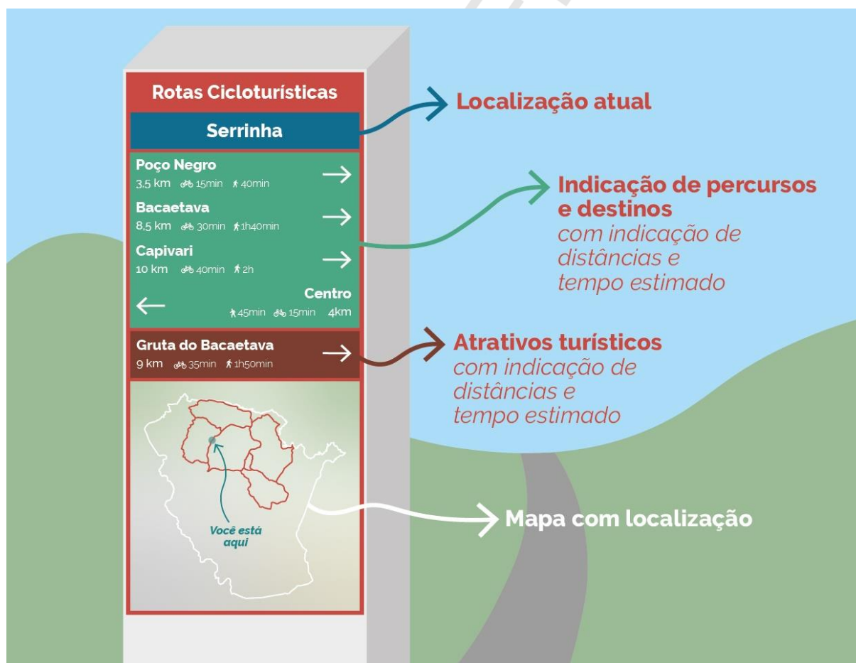
Figura 131 — Proposta de Sinalização Vertical para Circuitos Cicloturísticos
