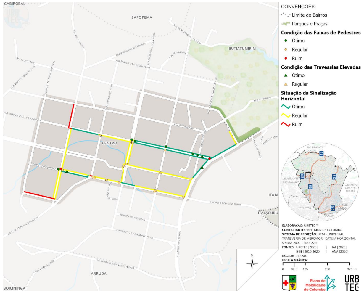
Figura 104 — Situação da sinalização horizontal e das faixas de pedestre e travessias elevadas nas rotas acessíveis do Centro
