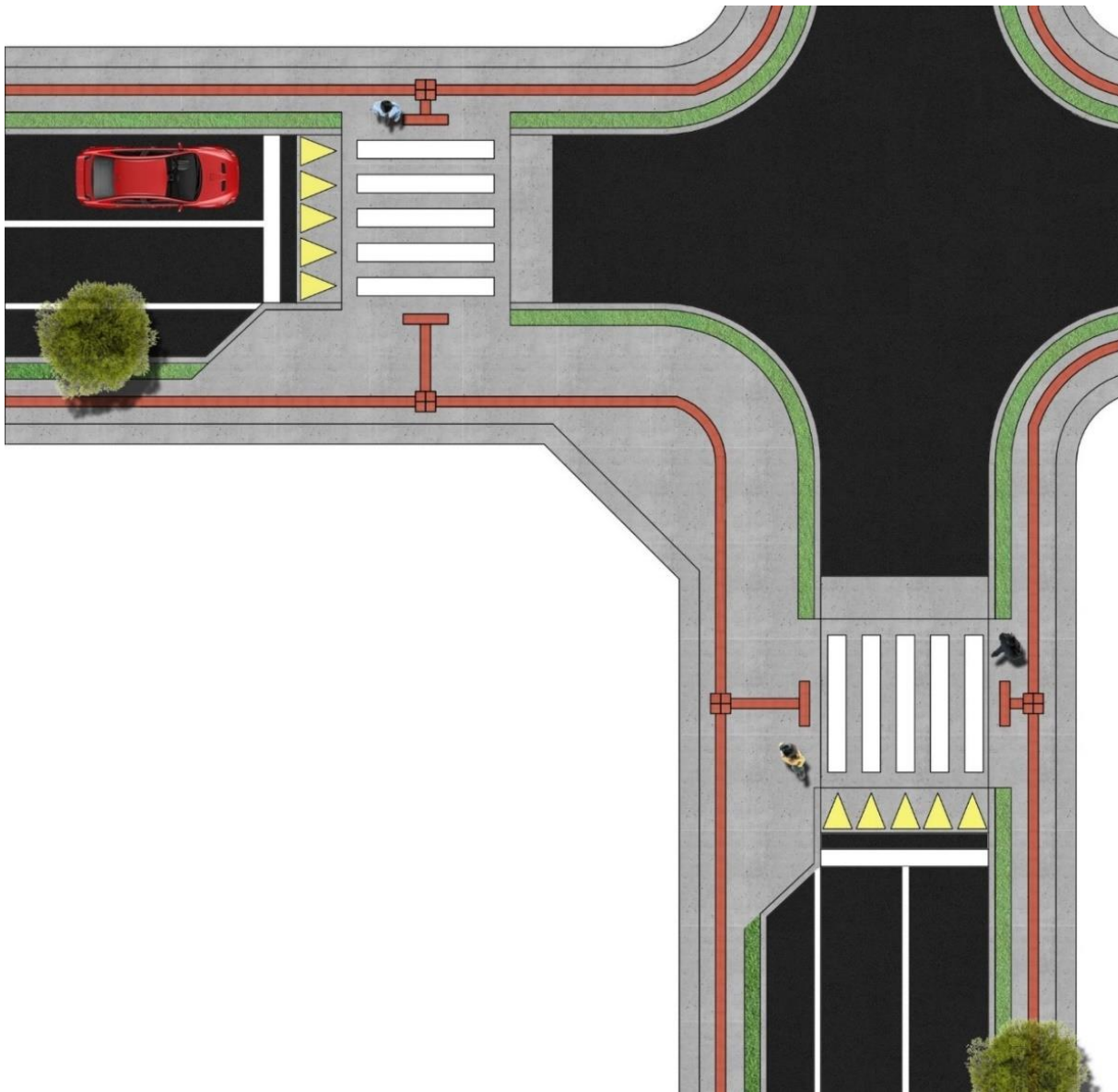
Figura 71 — Modelo de faixa elevada nos cruzamentos
