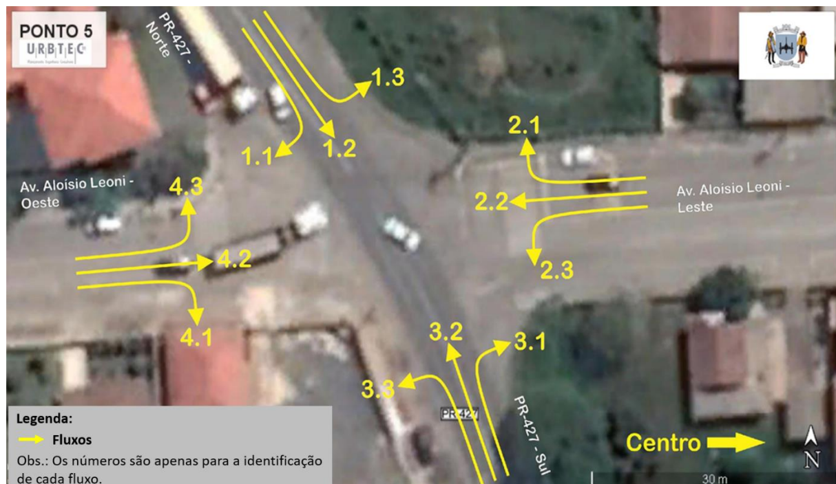
Figura 3 - Exemplo de croqui de fluxograma de movimentos de intersecções
