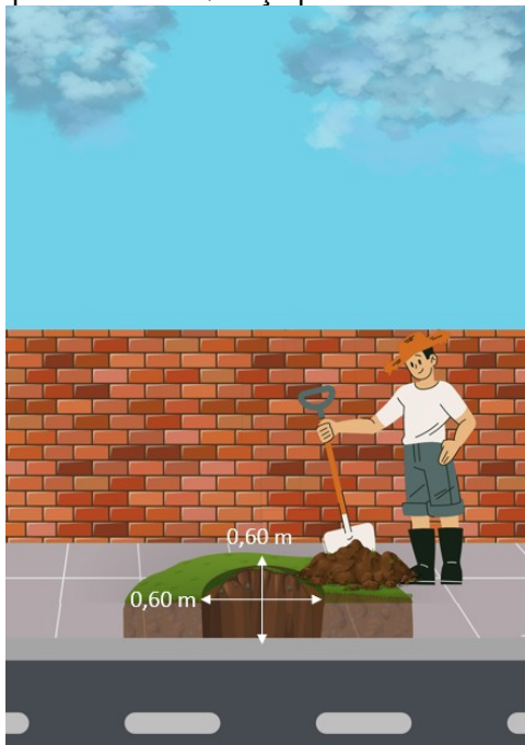
Figura 57 - Dimensões adequadas da cova/berço para as mudas da arborização de ruas
