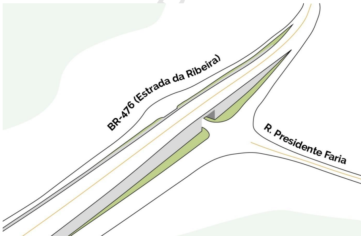
Figura 45 — Perspectiva da proposta de interseção em desnível Rod. BR-476 x Rua Pres. Faria
