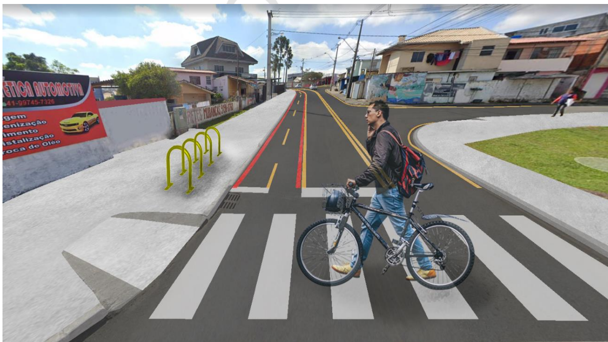
Figura 151 — Paraciclo ao longo da malha cicloviária — exemplo de aplicação na Rua da Pedreira
