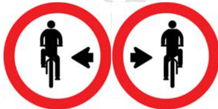
Figura 134 — Sinalização vertical: à esquerda, R-35a — ciclista transite à esquerda e, à direita, R-35b — ciclista, transite à direita
