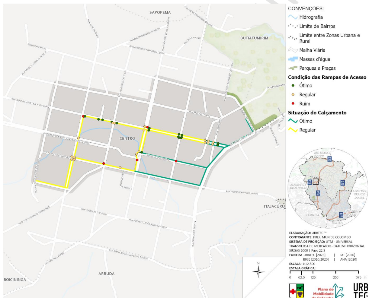
Figura 101 — Situação do calçamento e da condição das rampas de acesso nas rotas acessíveis do Centro
