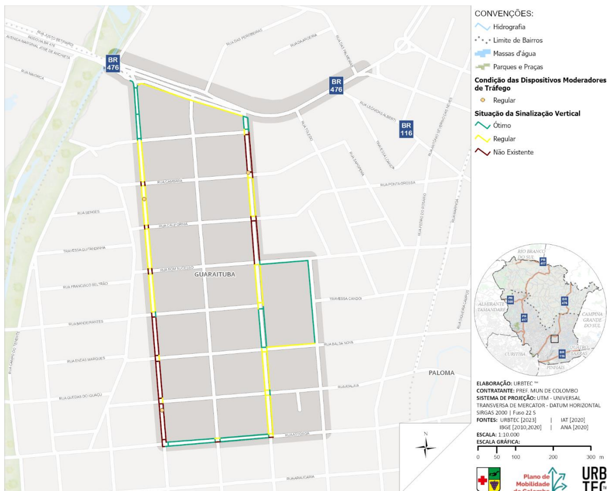
Figura 118 — Situação da sinalização vertical e dos dispositivos moderadores de tráfego nas rotas acessíveis do Guaraituba
