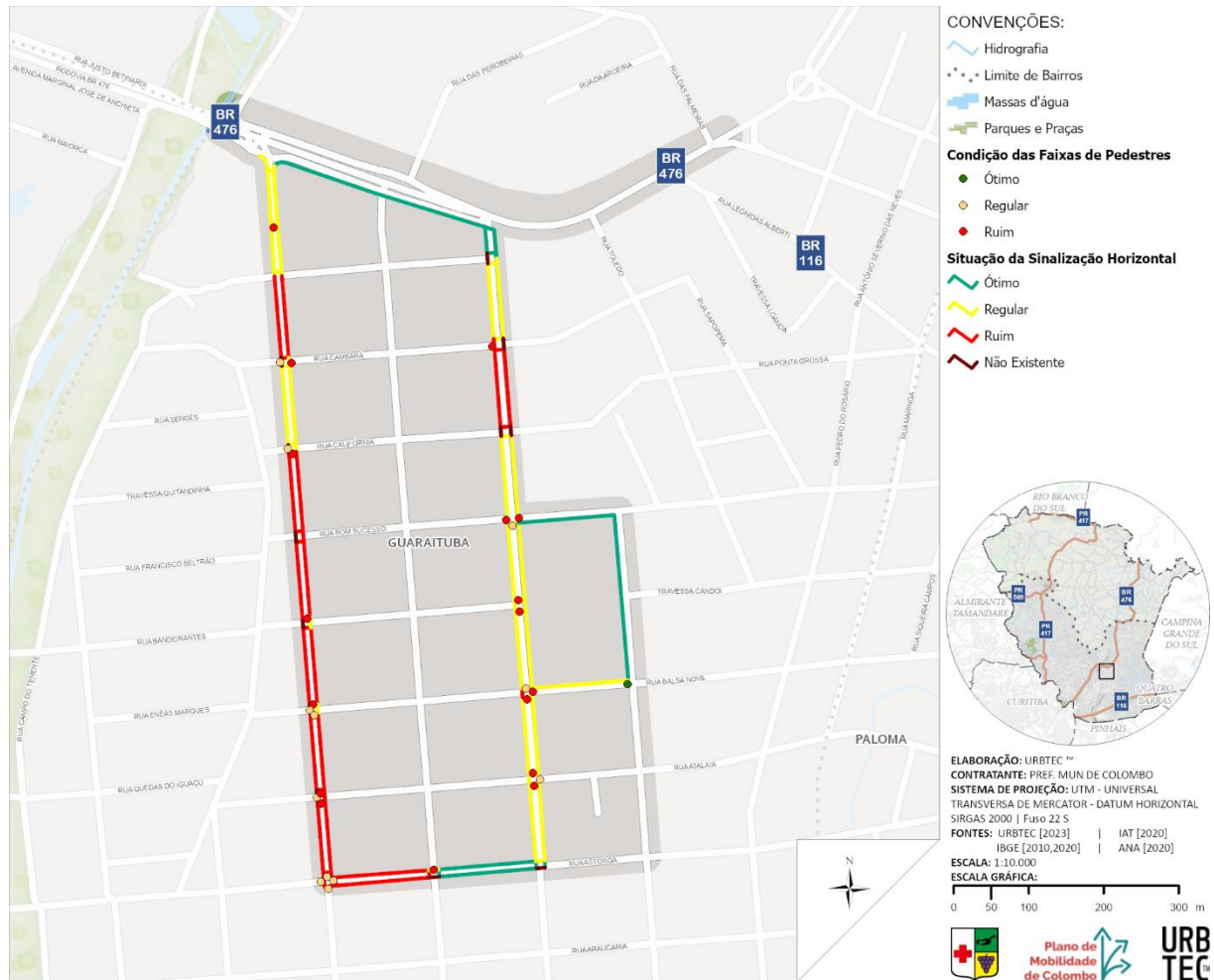
Figura 117 – Situação da sinalização horizontal e das faixas de pedestre e travessias elevadas nas rotas acessíveis do Guaraituba
