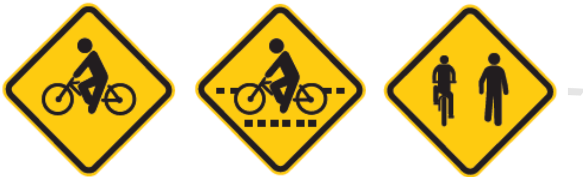
Figura 136 – Sinalização vertical: A-30a – “Trânsito de ciclistas”, A-30b – “passagem sinalizada de ciclistas” e A-30c – “trânsito compartilhado por ciclistas e pedestres”
