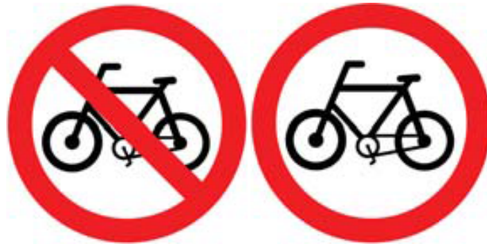
Figura 133 — Sinalização vertical: à esquerda, R-12 — Proibido trânsito de bicicletas e, à direita, R-34 — circulação exclusiva de bicicletas.
