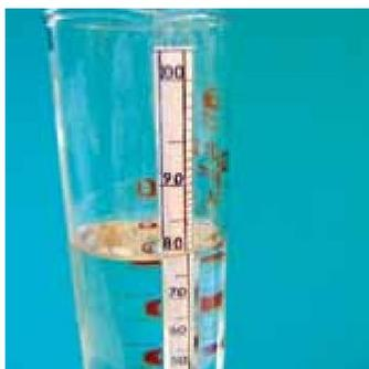
2 - A análise da produção final é obrigatória. Use o alcoômetro para controlar a concentração de álcool da solução final. Os limites aceitos devem ser fixados a  $\pm 5\%$  da concentração alvo (75% a 85% para o etanol).
