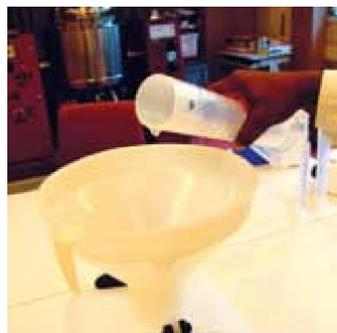
2 - O **peróxido de hidrogênio** é adicionado usando o cilindro de medição.
