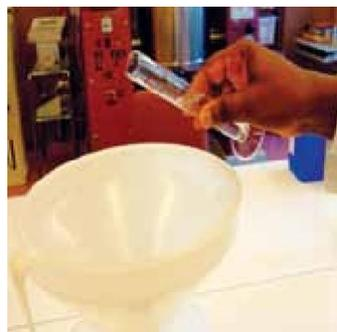
3 - O **glicerol** é adicionado usando um cilindro de medição (proveta).
