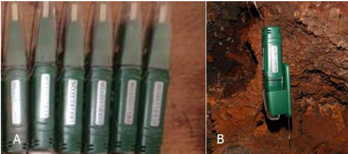
Figura 1/III - A) Dataloggers EXTECH utilizados para o monitoramento, B) Datalogger EXTECH instalados na Gruta do Bacaetava
